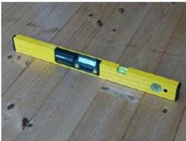
水平器による床の傾きの計測
